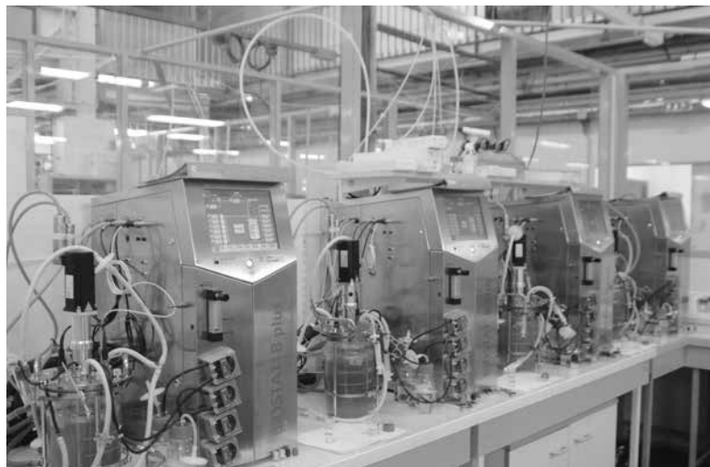
Plateau fermentation avec un alignement de fermenteurs de 2L et leurs centrales de contrôle pour réaliser la mise en culture de microorganismes
